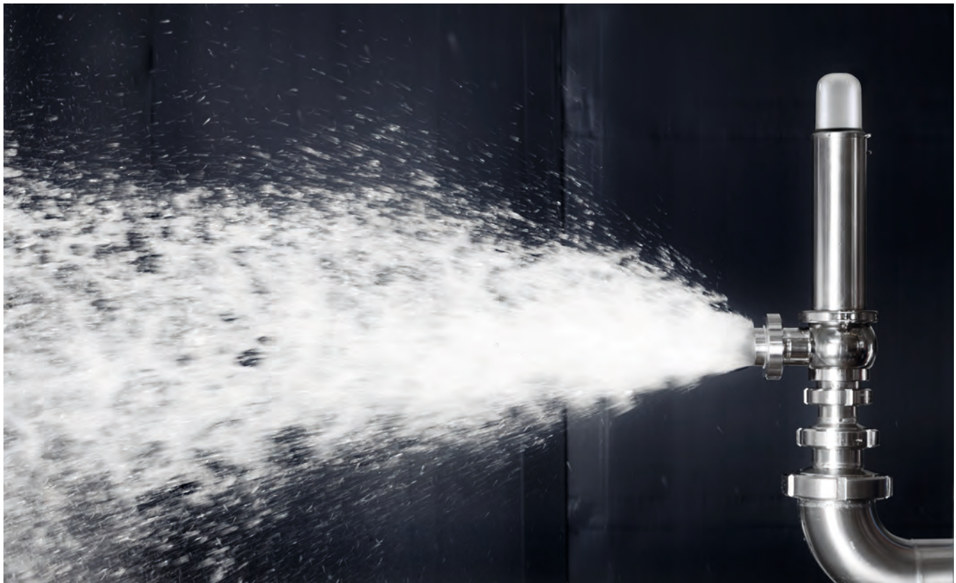
Sicherheitsventil im KIESELMANN Testcenter
