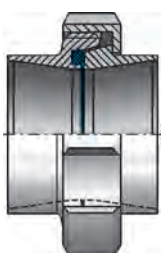
S-ISO-Rohrverschraubung 2103 mit Perbunandichtung
